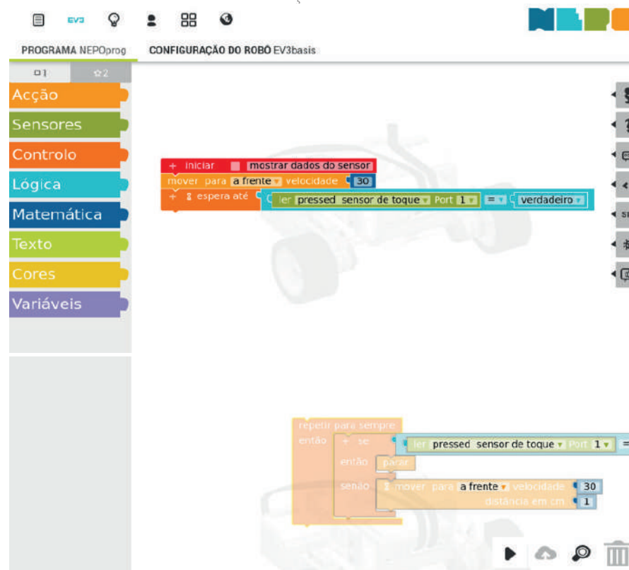
Figura IV.6.18 - Robô que interrompe sua movimentação quando detecta um obstáculo com o sensor de pressão.
