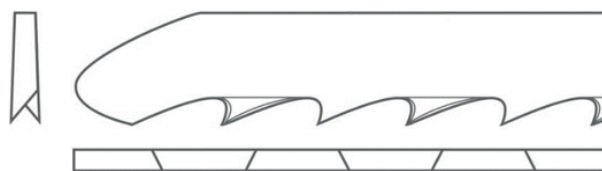
Figura IV.4.12 - Corte reverso. Fonte: https://www.kaury.com.br/ .
