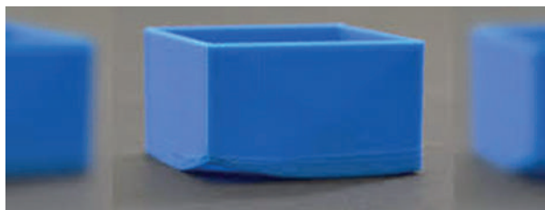
Figura IV.2.18 - Warping (empenamento). Fonte: Tech CD notícias (2021)
