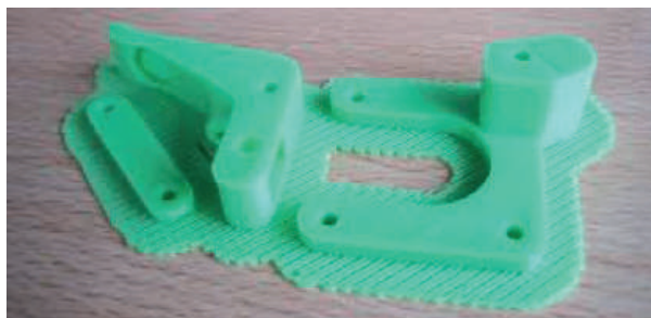
Figura IV.2.23 - Raft. Fonte: Iressoras3D.com (2018)
