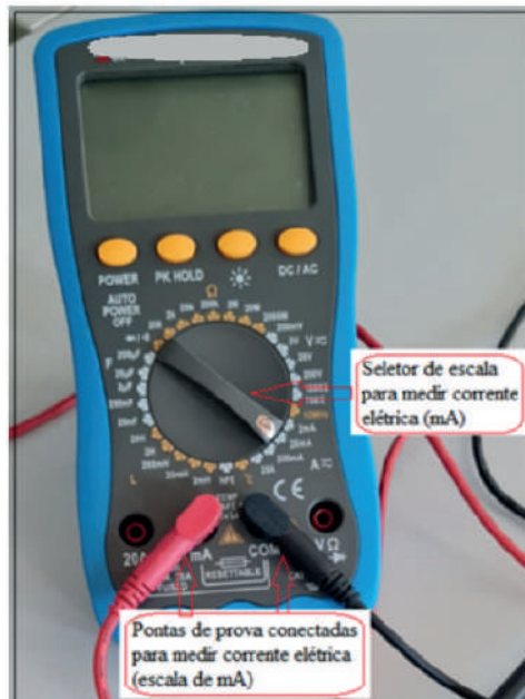
Figura IV.5.9 - Conexão das pontas de prova no multímetro para medir corrente elétrica.
