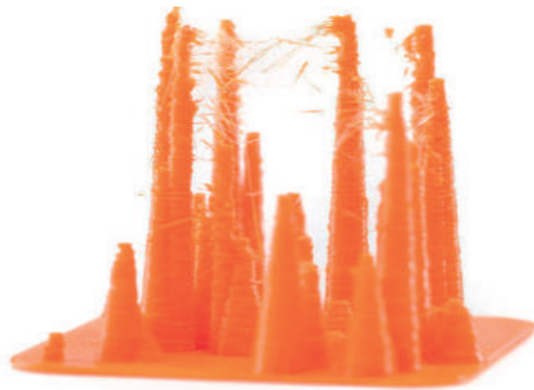
Figura IV.2.21 - Stringing. Fonte: Combtech
