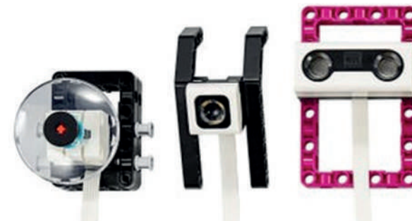
Figura IV.6.2 - Sensor de toque ou pressão (esq.); sensor de luminosidade e cor (centro) e sensor de distância ultrassônico (dir.). Adaptado de: lego.com.
